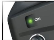
Wenn die Status-LED rot blinkt, sind eventuell die Batterien des Senders schwach, entladen oder nicht richtig installiert. Ersetzen Sie sie mit neuen oder frisch geladenen Batterien. Die Anzeigelampe zeigt nicht den Ladezustand der im Modell installierten Batterie an. Mehr Informationen über Sender, Statusanzeige und LED-Signale finden Sie auf Seite 15 im Abschnitt Fehlerbehebung.
